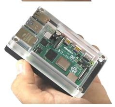
Nun müssen Sie die beiliegenden Kühlkörper auf den Raspberry Pi kleben. Dazu kommt der große Kühlkörper auf den CPU, der Mittlere auf den Arbeitsspeicher und der kleine Kühlkörper kommt auf den USB3.0-Controller.
