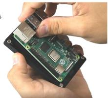
Anschließend wird das mittlere (leicht transparente) Stück des Gehäuses eingesetzt. Die Magnete halten es an der richtigen Stelle.
